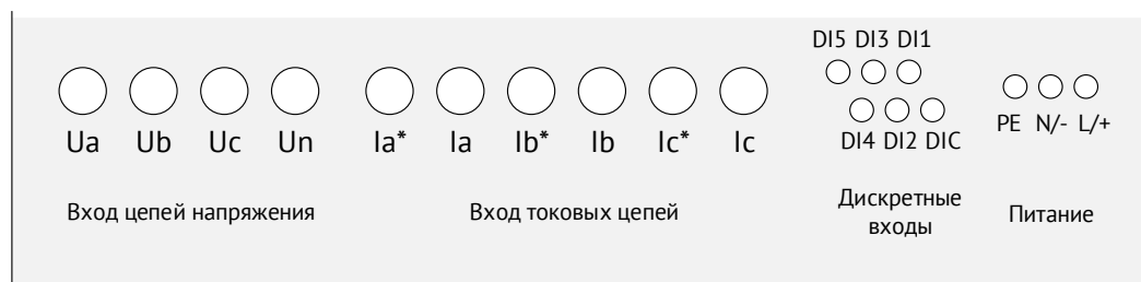
Рисунок 1.14. Расположение клемм ЭНИП-2-...-Х3.
