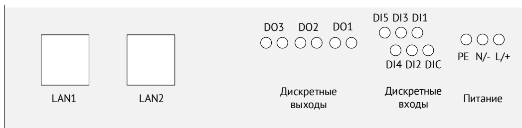
Рисунок 1.15. Расположение клемм и интерфейсов ЭНИП-2-0-...-Х3.
