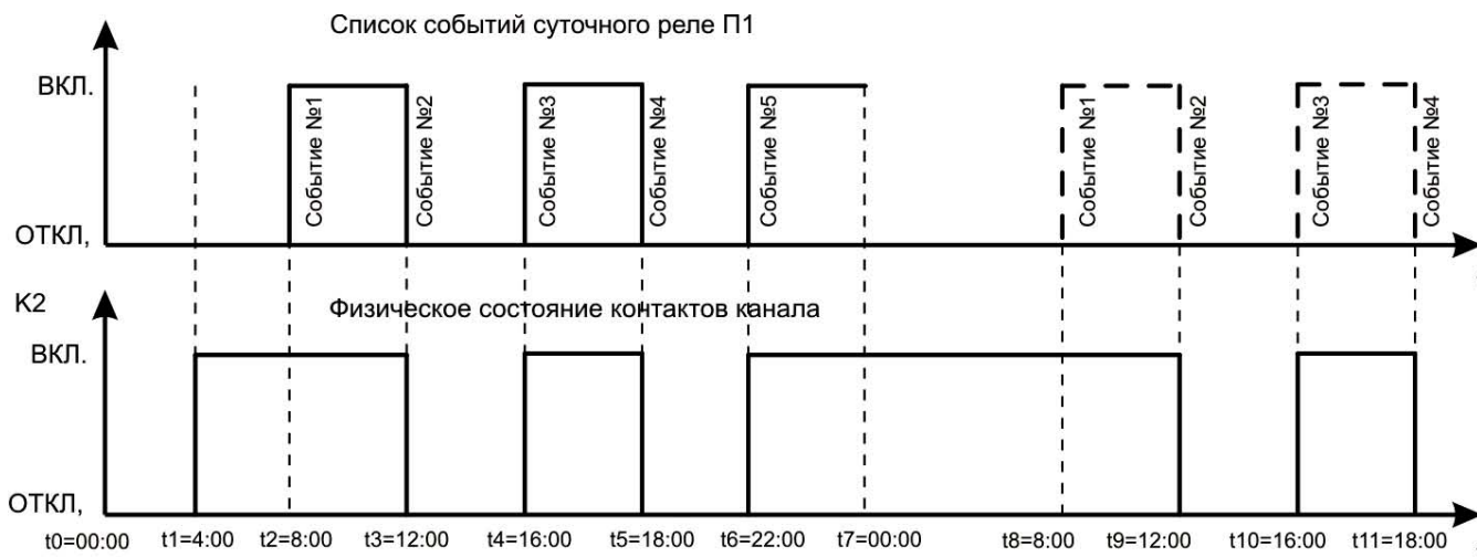
Рисунок 2.8 - Режим циклического выполнения списка таймеров на примере суточного реле времени
